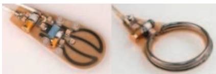
■ 図2 NMR検出部分の表面コイル形状
