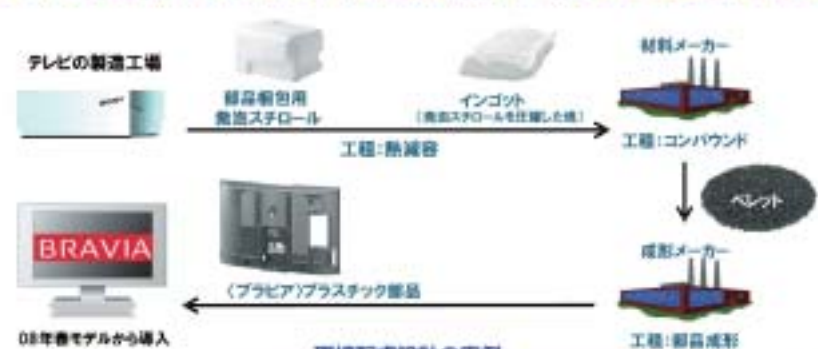
テレビの製造工場から排出される部品梱包用発泡スチロールをブラビア部品として再生
