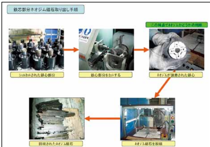
図2 鉄芯部分ネオジム磁石取り出し手順
