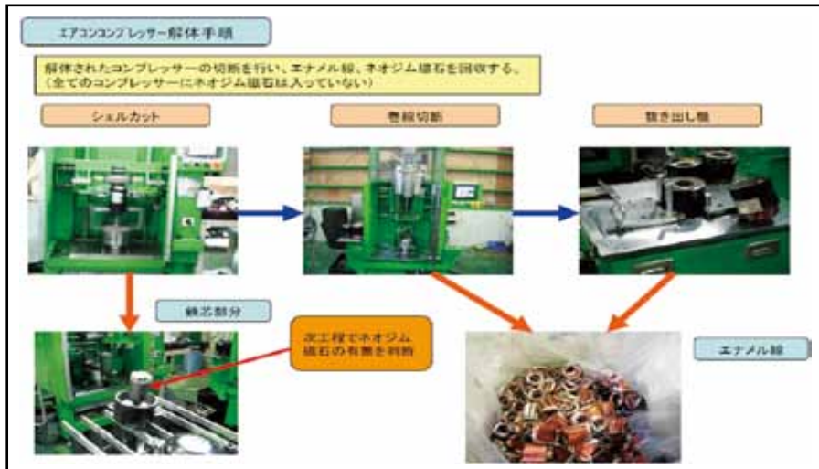
図1 エアコン・コンプレッサー解体手順
