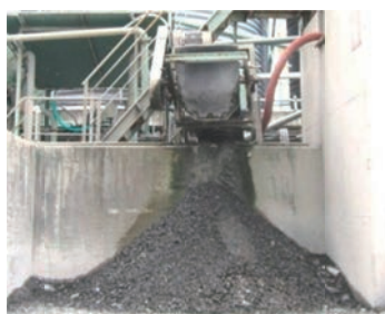
写真2 洗浄水からの骨材回収状況
