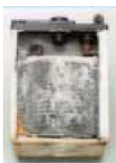
サルフェーションで劣化したバッテリー
