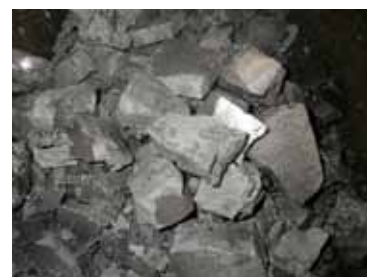
スラグ／銑鉄分離後の破碎スラグの外観
