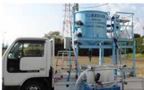
移動型リン回収装置を用いたリン回収プロセス
