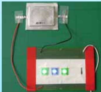
小型ラミネート型電池試作(オリビン型リン酸鉄リチウム)
