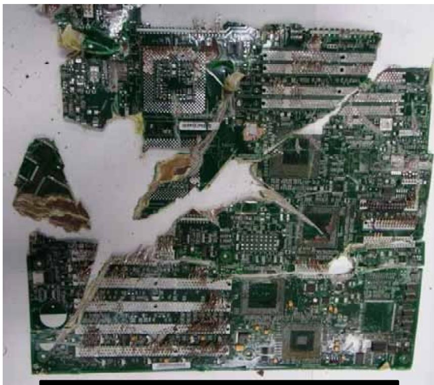
剥離破碎後の基板
