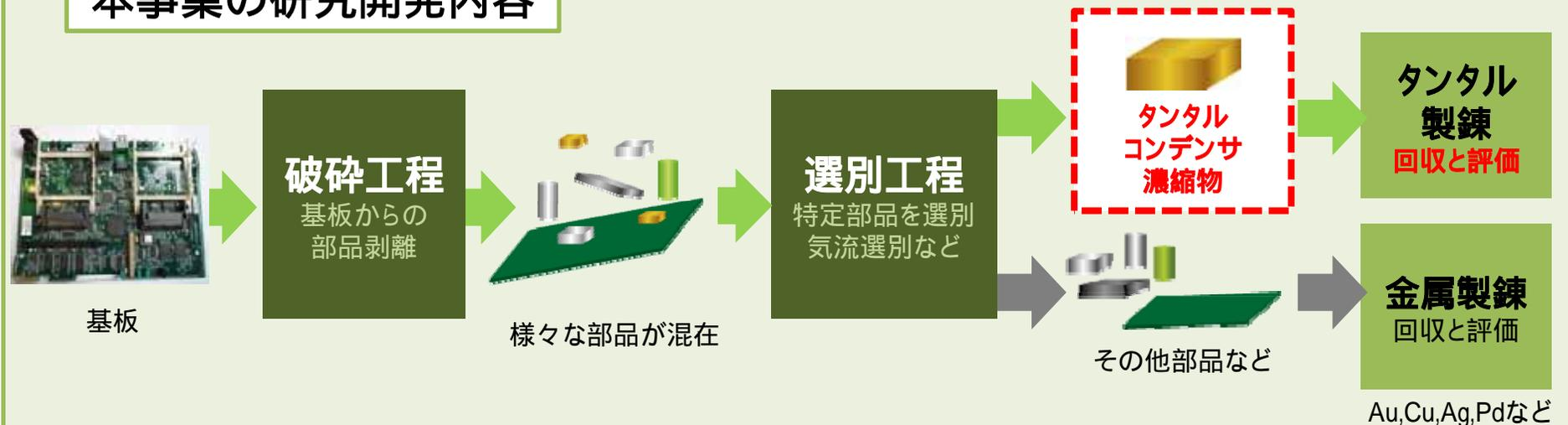
破碎・選別工程の構築・実証試験・経済性の評価
