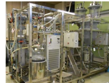
Nd・Dy等回収実証試験装置
