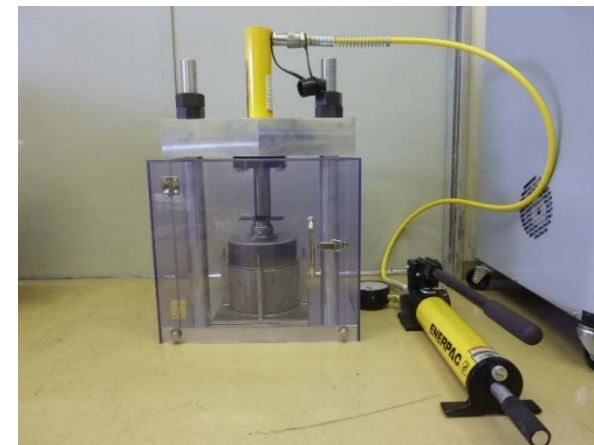
開発した2次解体装置（可搬型）
