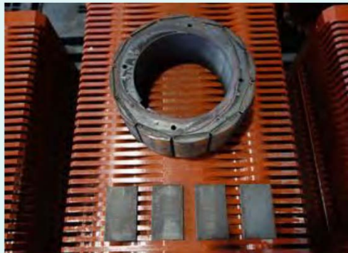
加熱処理後の鉄心とNd磁石
