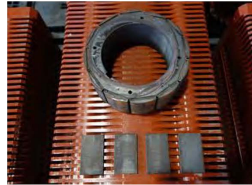
加熱処理後の鉄心とNd磁石
