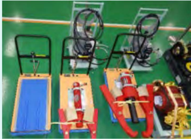
ロータ受け台 300kN用 500kN用 多目的油圧プレス機
