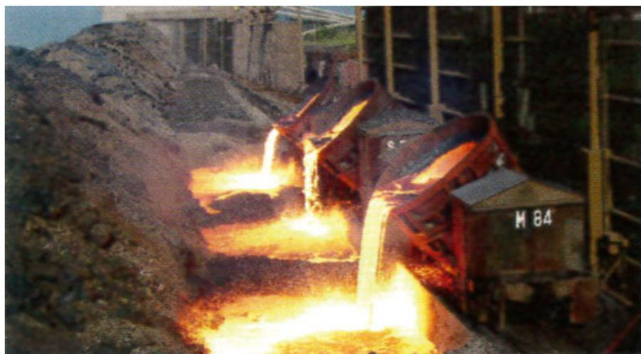
製鋼スラグ中 (T.Fe)、(P<sub>2</sub>O<sub>5</sub>) は鉄鉍石、リン鉍石の含有量と比較すると圧倒的に低いですが、製鋼スラグ発生時の温度は1300°C以上ある。
