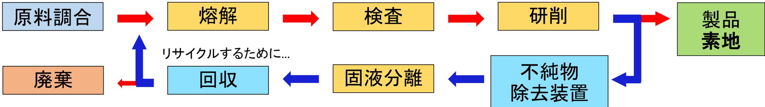
・特定硝種の研削スラッジから不純物を分離回収し、ガラス熔解に再利用する事により産業廃棄物の削減と、レアメタル原料である酸化タンタルの使用量、及び、購入量の抑制を実現することに成功した。
