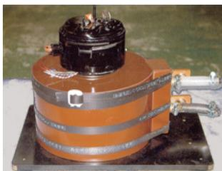
■ 図11 エアコンコンプレッサ切断品の脱磁試験
