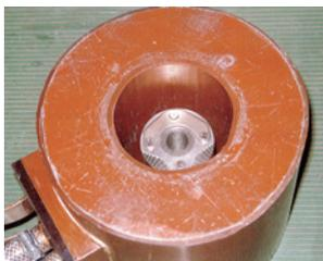
■ 図10 エアコンコンプレッサ用ローターの脱磁試験
