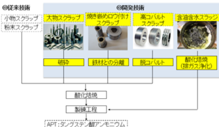
図1. 新たに開発したリサイクル処理技術
