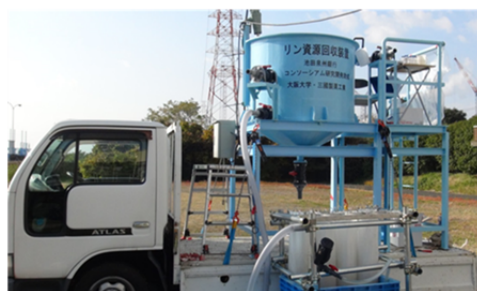
移動型リン回収装置を用いたリン回収プロセス
