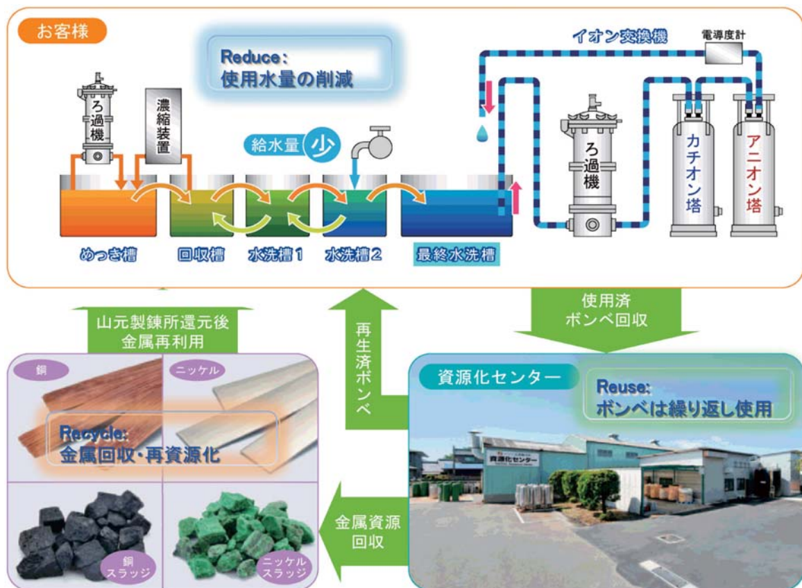
図1 ポンベ型イオン交換機によるめっき水洗工程のクローズド化システム概要図
