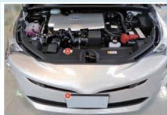
① ラジエーターボートオープニングカバー ② フロントバンパーエクステンションマウンティング 自動車エンジンルーム部品 写真提供：いその(株)
