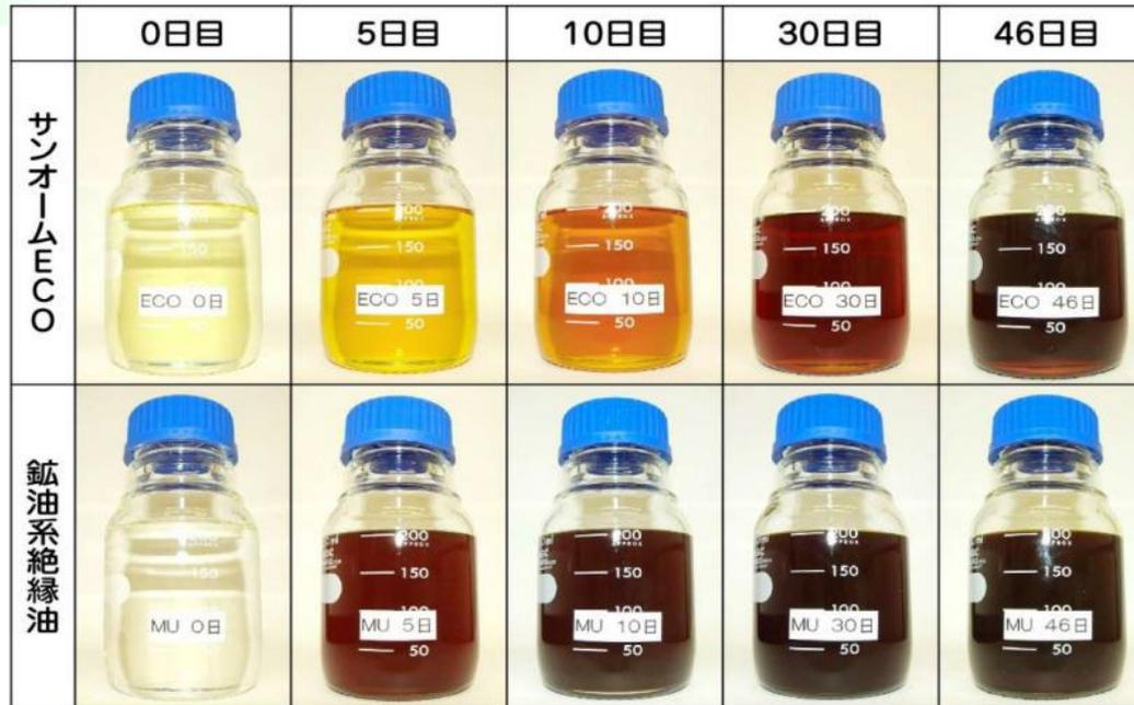
サンオームECOは、劣化してもスラッジ（固体劣化生成物）が発生しないため、絶縁破壊電圧が低下しません。
