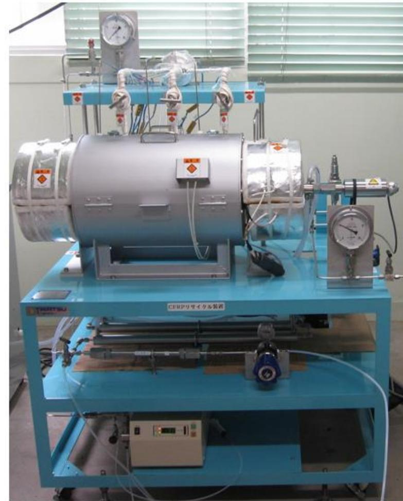
1. 分解溶媒 2. 高圧ポンプ 3. 電気炉 4. 予熱コイル 5. 反応器(4.7L)
