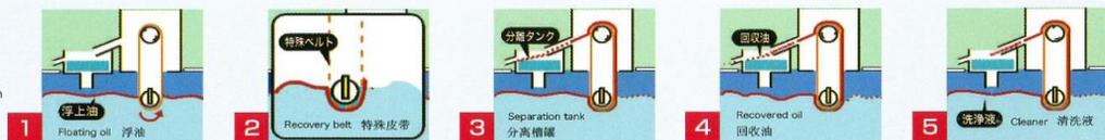
各種切削タンクや洗浄槽に浮上する浮上油を、特殊開発のベルトで回収し、加工精度の向上・切削後の腐敗劣化防止・洗浄精度の向上に貢献します。ベルトが液の中に入る時に、浮上油を付着させていくのが特長です。また、洗浄機用TB-75型は切削油を洗い落とし汚れた液及び浮上油を早く・多く回収するような特殊ベルトを、クーラント用RB-200型は潤滑油等の浮上油を効率よく回収する特殊ベルトを用いております。
